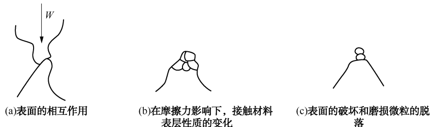
图 2-13 磨损微粒形成的疲劳模型
